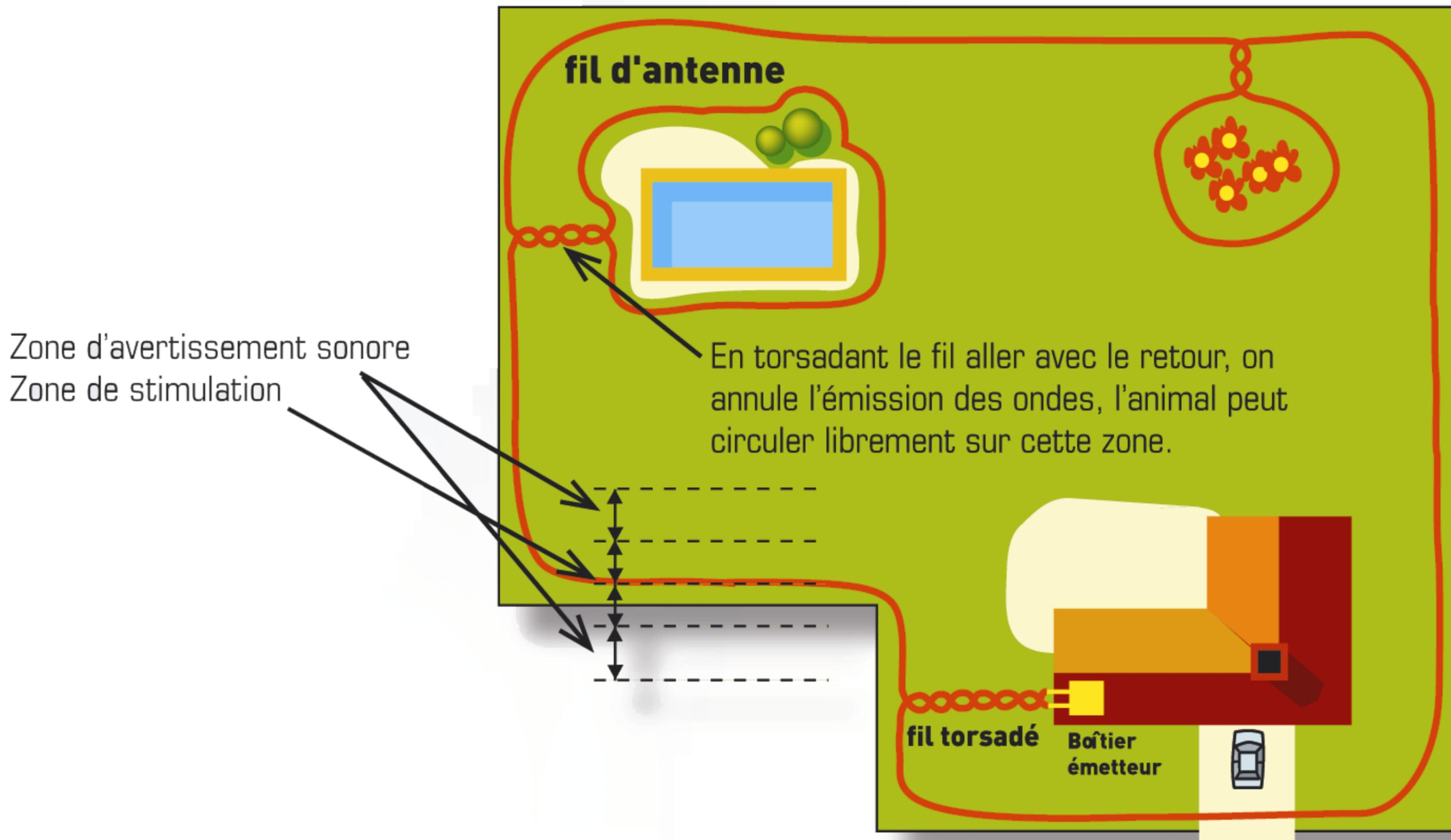
Le fil est posé au sol, enterré ou aérien. Pour que le système fonctionne, le fil doit former une boucle ininterrompue.
